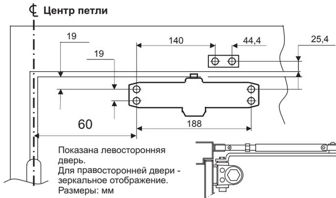
1. Используя размеры, указанные в таблице и на рисунке слева, разметьте 4 отверстия на двери для доводчика и 2 отверстия на верхней планке дверной коробки для рычажного башмака.
