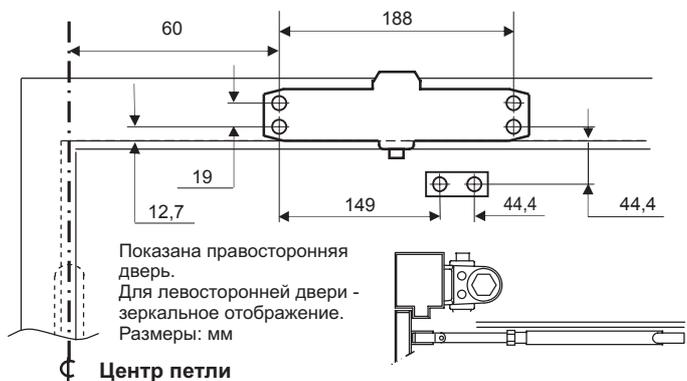
1. Используя размеры, указанные в таблице и на рисунке слева, разметьте 4 отверстия на дверной коробке для доводчика и 2 отверстия на двери для рычажного башмака.
